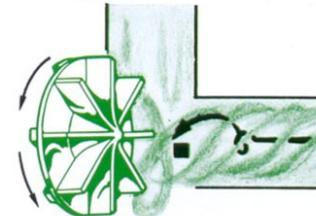
A maioria das partículas são descarregadas em menos de uma revolução devido à força centrífuga induzida pela ação do vortex.
